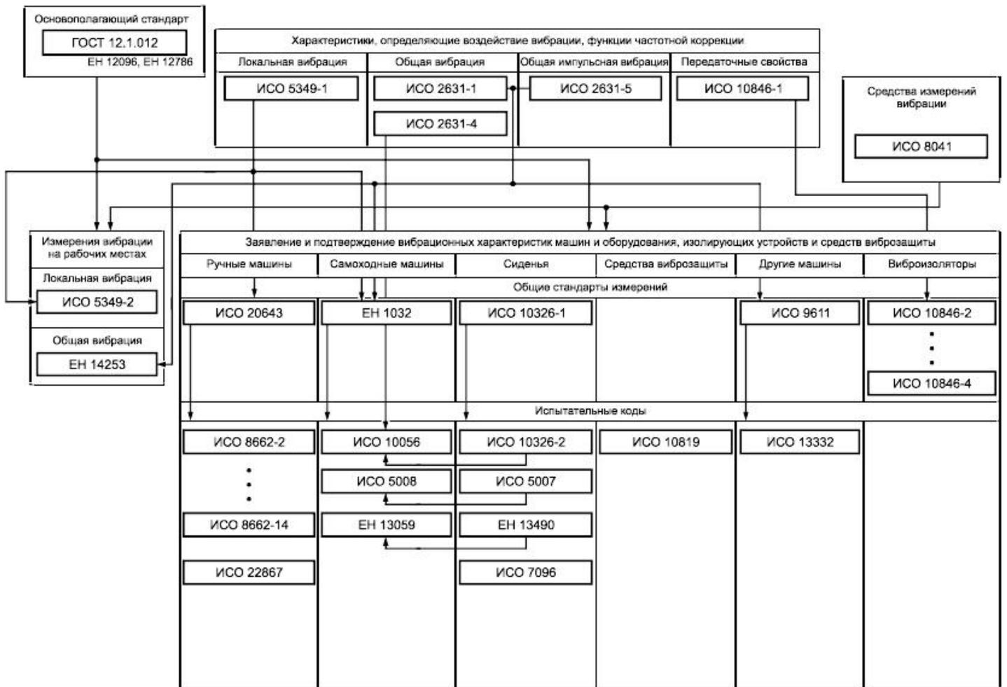
Рисунок В.1 - Схема комплекса международных и европейских стандартов в области вибрационной безопасности
