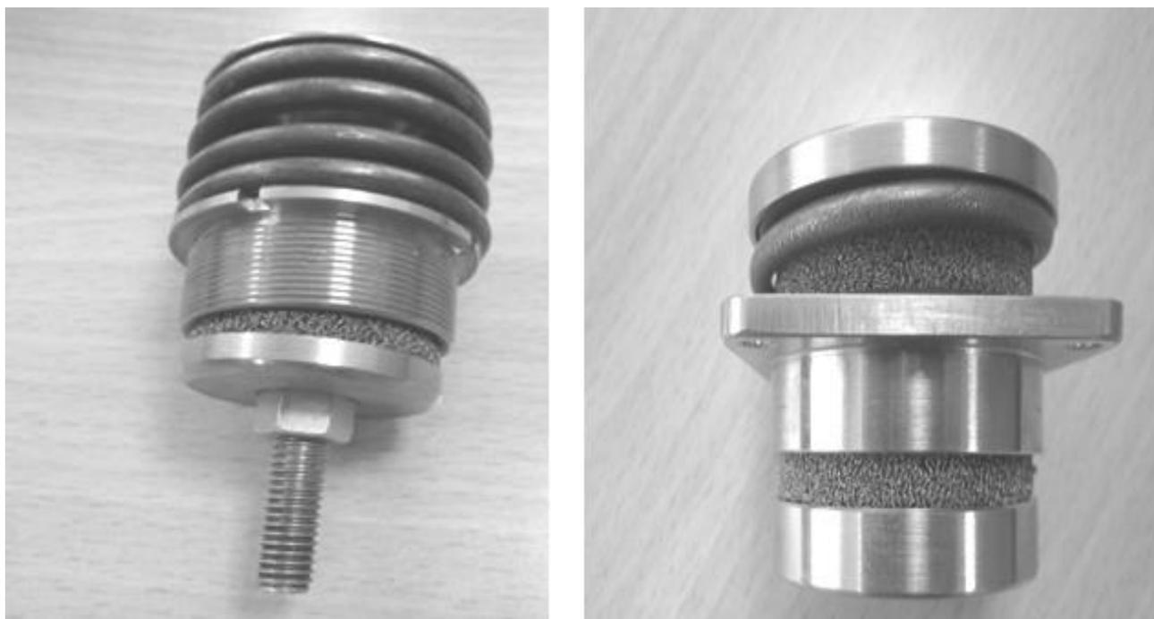
Рисунок 1 – Спроектированные цельнометаллические виброизоляторы втулочного типа с УГЭ из материала МР
