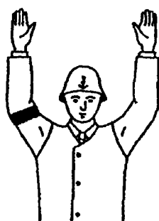
Рис. 11. Обе руки подняты вверх. Ладонями рук произвести движение в сторону дальнейшего перемещения груза и резко опустить руки вниз
